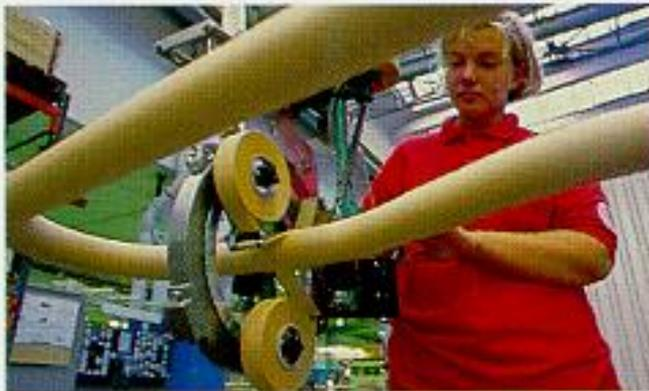
**El aislamiento del conductor primario, "horquilla de pelo" para los IMB.**
